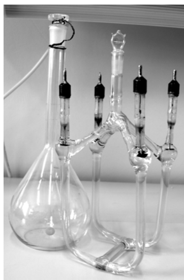
Рис. 1. Четырехэлектродная ячейка для измерения сопротивления концентрированных растворов (для сравнения приведена колба объемом 500 мл).
