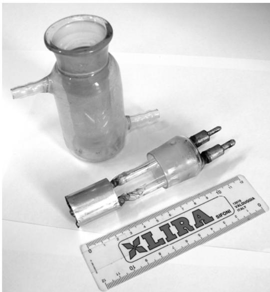
Рис. 1. Фотография ячейки для диэлектрических измерений жидкостей.
